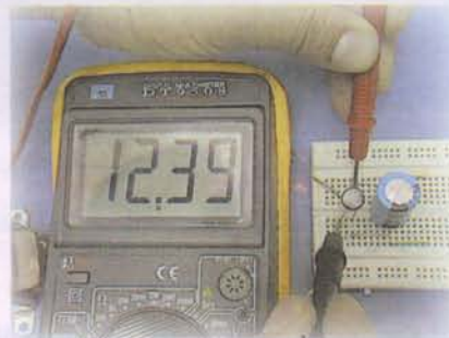
Figura 7.70. Medición del voltaje de salida del rectificador con filtro y sin carga
